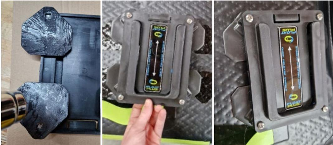
Schrauben Sie die Schieber vorsichtig von den Pads ab und drücken Sie sie fest an, insbesondere die Kanten. Kontrollieren Sie die Pads immer wieder und drücken Sie sie an, und kleben Sie sie gegebenenfalls mit Klebeband fest.
